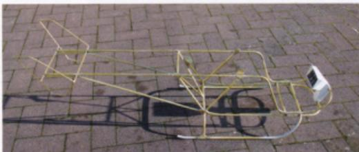
Löten, löten, löten – dann putzen, feilen, schleifen, entfetten. Und sich schon mal aufs Lackieren freuen. Aber in welcher Farbe?
