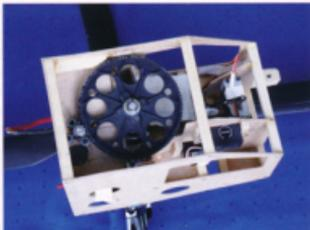
Der ausgebaute Funktionsblock, zuständig für E-Antrieb, Getriebe, Rotoren, Rudermaschinen, Kreisel und Empfänger, soll auch das Herzstück dieses »ultraeichten« Flettners werden. Gesteuert vom Test-Piloten »Bärli«.
